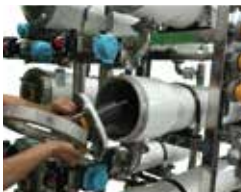
快拆式膜管，方便RO膜的拆装
